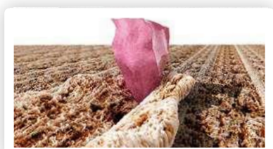
➤ Зерно оксида алюминия царапает древесину мягких пород.
